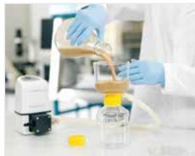
2. 稍加摇晃将细胞培养液和助滤剂混合均匀, 将混合液倒入Sartolab<sup>®</sup> RF 中。
