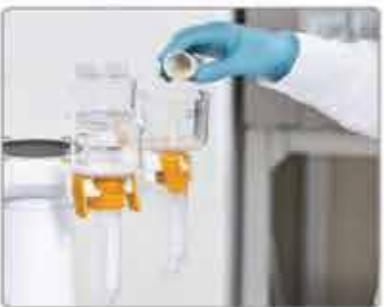
2.将细胞培养液和助滤剂混合液倒入 Sartolab® RF 中。
