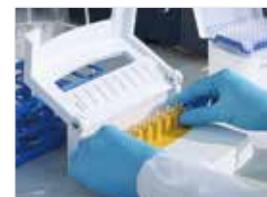
4.打开盖子、移走过滤单元, 将收集瓶内过滤好的样品取走分析
