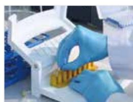
1.先将样品收集瓶依次插入托盘, 再将过滤单元放置在收集瓶之上
