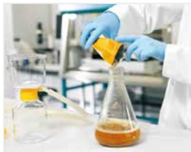
1. 将 Sartolab<sup>®</sup> RF 装置安装至真空源。将助滤剂倒入细胞培养液。
