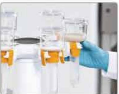
3.推动过滤装置以对其抽真空，并开始过滤(二次推压)。
