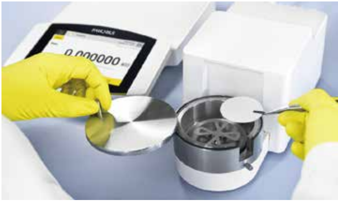
图1:配有适用于滤膜称量的防风罩 F 的 Cubis® II MCA2.7S 超微量天平
