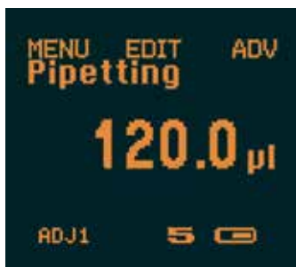
使用中按照 ADJ1 指示进行校准调节
