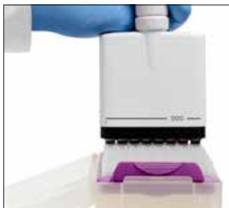
小心地将吸头安装到移液器上，并利用 Optiload 吸头安装装置。
