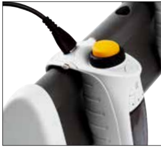
赛多利斯电动移液器可在移液时对其进行充电。
