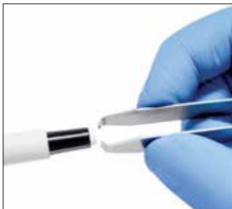
安全圆锥过滤器能保护移液器不受污染，并且应定期更换。
