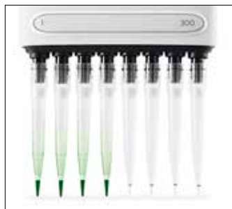
右侧的四个吸头为低吸附吸头，可最大程度地提高样品回收率
