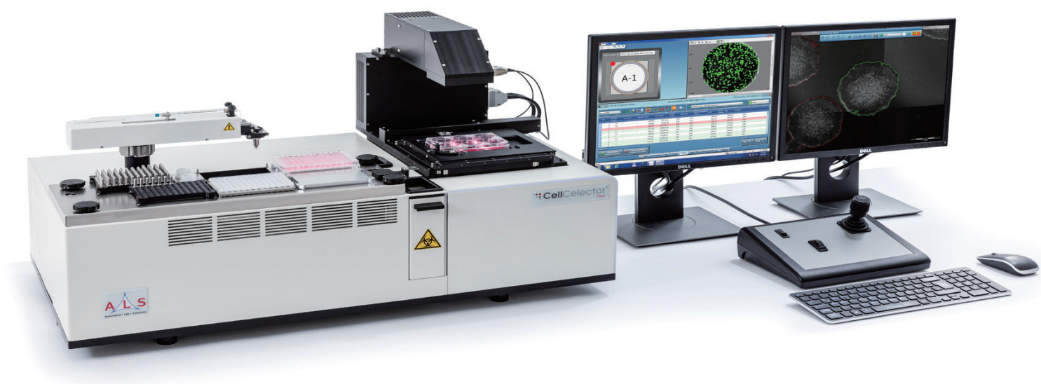
图 1. CellSelector 的典型配置：主机单元放置于生物安全柜内，电脑工作站独立放置于安全柜外部。
